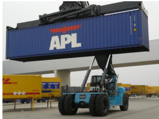
Konecranes Reach Stacker im Einsatz. Hintergrund: Brücke für Pakettransport
