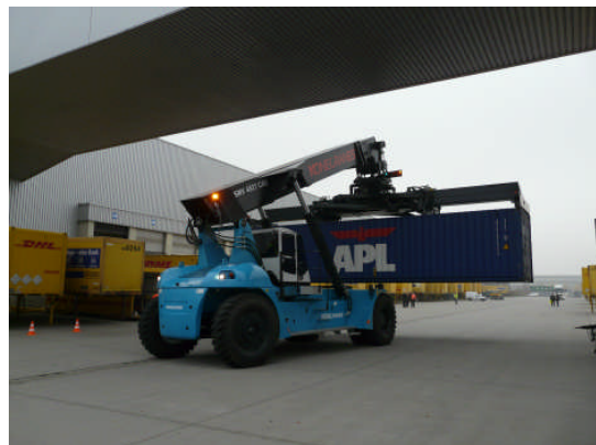
Keine Gefahr für die Brücke: heruntergefahrener Ausleger
