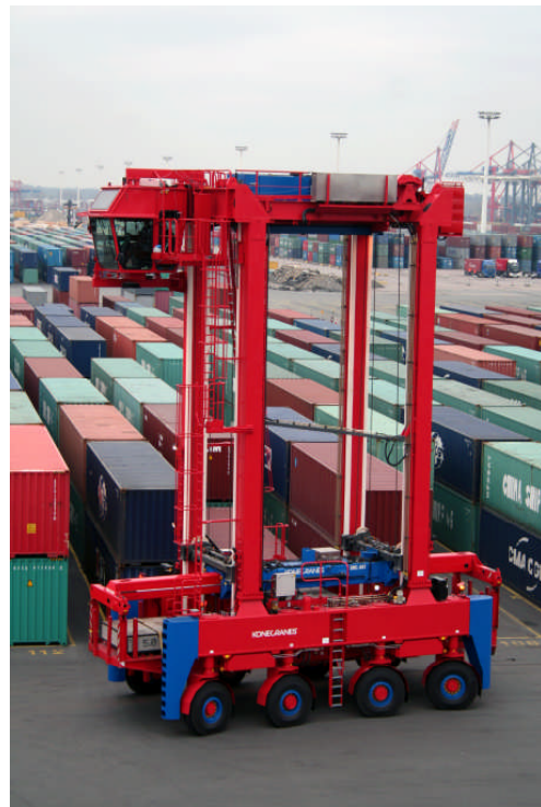
Konecranes DE 54 (50 t SWL, 1 über 3 Container = 4 hoch) im Betrieb
