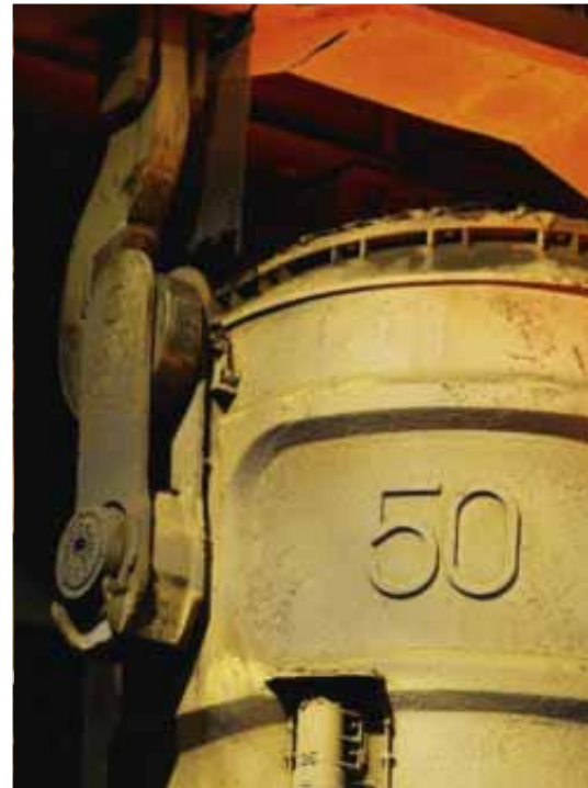
Der BS 5a gleitet über das Stahlgerüst. Bei einem Eigengewicht von 900 Tonnen Stahl auf Laufrädern kann er mehr als 425 Tonnen heben.
