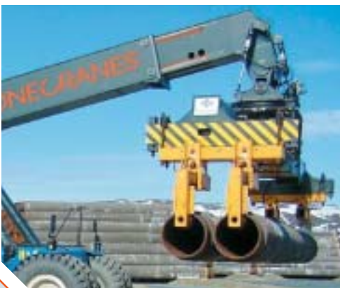
Hubeinheit für Rohre.
