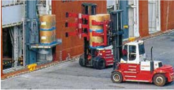
Papierrollen sicher im Griff. Mit Anbauelementen können 2, 4 und 6 Rollen bewegt werden (12 – 16 Tonnen).
