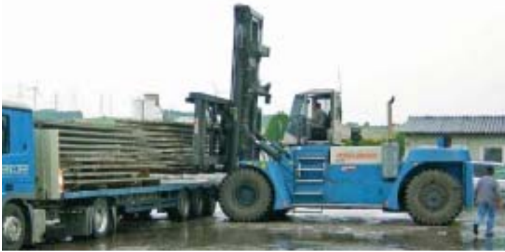
Für schwere Betonelemente werden breite Gabelträger und eine Seitenkabine benötigt (16-42 Tonnen).
