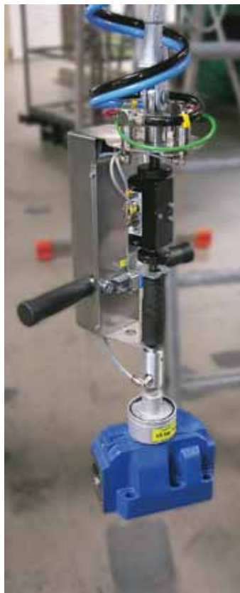
Magnetgreifer können mit pneumatisch umschaltbaren Permanentmagneten oder Elektromagneten ausgestattet werden.
